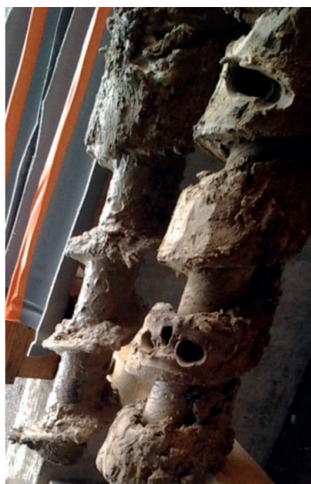
Figure 5: Sondage au carottier double-enveloppe sous gaine (à gauche), sondage à la tarière hélicoïdale (à droite).
