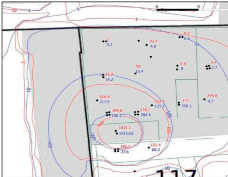
Figure 3 : Panache de PCE dans l'air de la zone non saturée entre 30 et 60 cm de profondeur - Concentrations en mg/m 3 .
